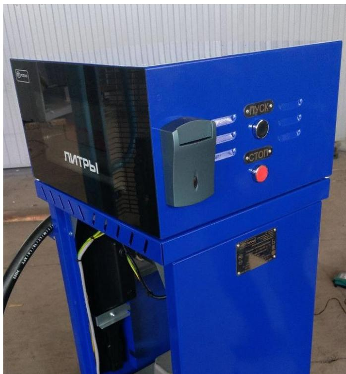
Рисунок 3 – Установка считывателя ключей/карт MATRIX III на ТРК «ТОПАЗ-511»
