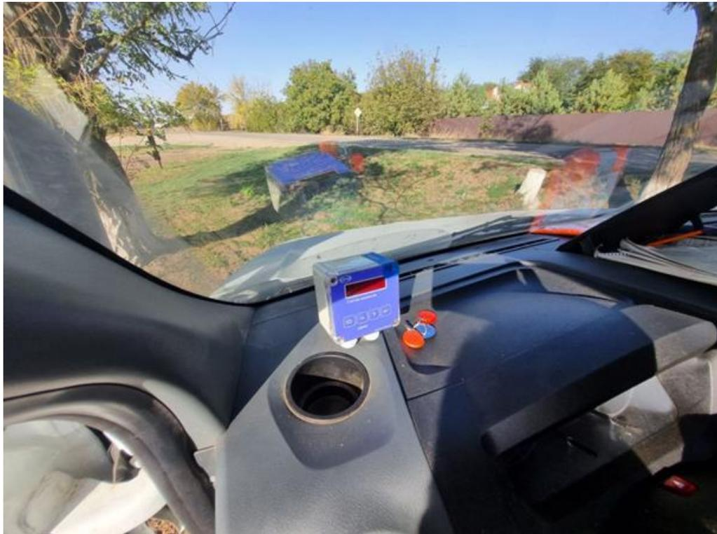
Рисунок 4 – Установка счётчика импульсов на АТЗ ГАЗ-53
