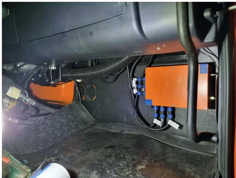
Рисунок 2 – Установка блока СКВТ на АТЗ КАМАЗ (под передней панелью ТС со стороны пассажира)
