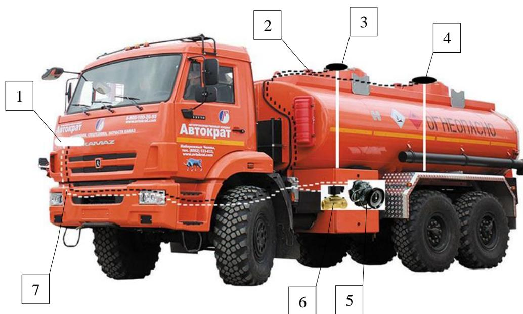
Рисунок 9 – Прокладка линий подключения периферийных устройств на АТЗ КАМАЗ (1 – штатное отверстие для ввода кабелей; 2 – трасса ДУТ; 3 – ДУТ 1; 4 – ДУТ 2; 5 – счётчик жидкости; 6 – клапан; 7 – трасса счётчика и клапана)
