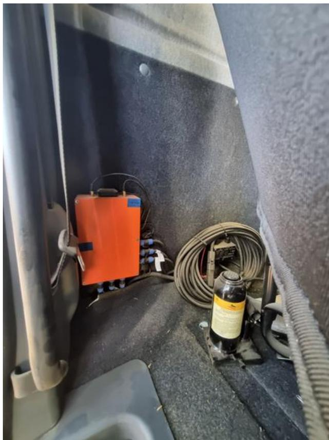
Рисунок 1 – Установка блока СКВТ на АТЗ ГАЗ-53 (на задней стенке кабины за сиденьем пассажира)
