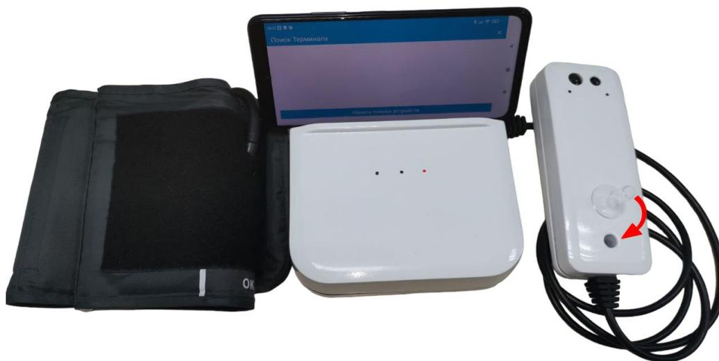
Рис. 5 Подключение воронки /мундштука к выносному блоку ИТТКПА
