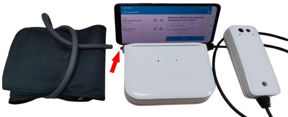
Рис. 4 Подключение манжеты к базовому блоку
