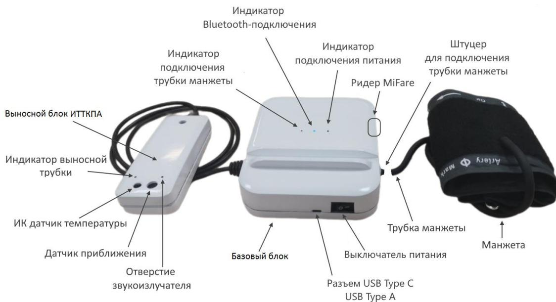
Рис. 2 Составные части комплекса
