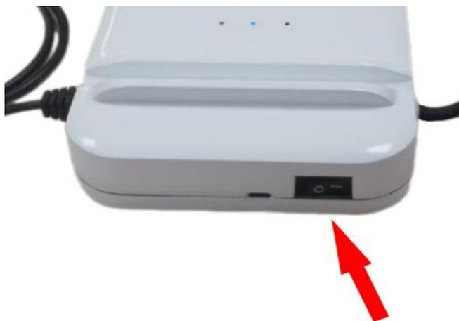
Рис. 8 Кнопка включения/выключения питания на боковой грани базового блока
